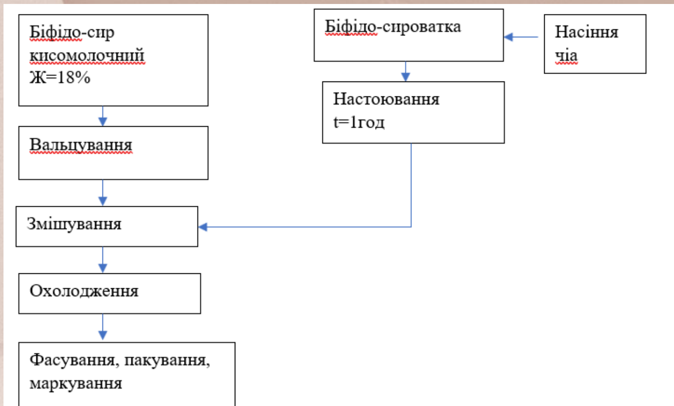
Рис.2 Векторна схема виробництва сиркового десерту з насінням чіа
