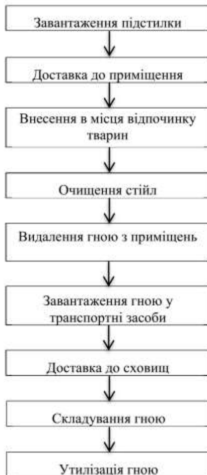
Рис. 3. Схема технологічного процесу прибирання приміщень, видалення та утилізації гною
