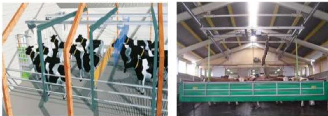
Рис. 21. Механічний підгонщик корів
