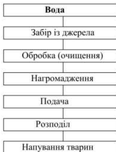
Рис. 6. Схема технологічного процесу водопостачання ферми та напування тварин
